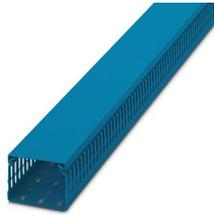
Goulotte pour l'installation et le montage dans des armoires électriques, bleue, exempte d'halogène, composée d'une partie supérieure et inférieure, largeur : 80 mm, hauteur : 60 mm, longueur : 2 000 mm
