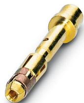
Contact à sertir, Connecteur femelle, tournés, Contact unique, diamètre de contact: 1 mm, zone de sertissage: 0,06 mm<sup>2</sup> ... 0,25 mm<sup>2</sup>, Produit de remplacement selon RoHS II sans exception 6c (Pb < 0,1 %) référence : 1243216
