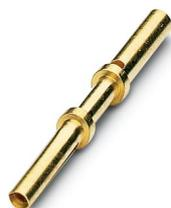
Contact à sertir, Connecteur femelle, tournés, diamètre de contact: 0,6 mm, zone de sertissage: 0,06 mm<sup>2</sup> ... 0,25 mm<sup>2</sup>, Produit de remplacement selon RoHS II sans exception 6c (Pb < 0,1 %) référence : 1242314
