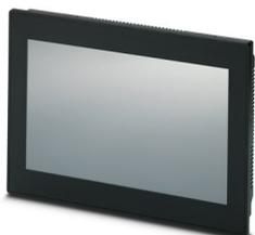
Écran tactile avec TFT 25,7 cm/10,1"-écran (résistive analogique), 1024 x 600 pixel(s) (WSVGA), 16,7 millions de couleurs, Arm<sup>®</sup> Cortex<sup>®</sup>-A7, 528 MHz i.MX6 UL, 2x COM (RS-232/422/485), 1x USB 2.0, Typ A, 1x USB 2.0, Typ B, 1x Ethernet (10/100/ MBit/s), RJ45, Windows<sup>®</sup> Embedded Compact 7 et logiciel utilisateur: Visu+. (système de bus: sans)
