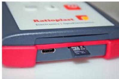
Bild 7 USB-Schnittstelle und microSD-Kartenslot
