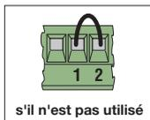
Contact radio et/ou bouton pour commande (**contact N.O.**)
