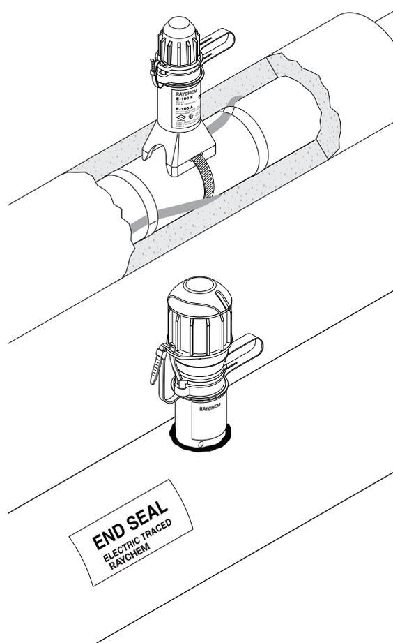
Les modèles nVent RAYCHEM E-100-E et E-100-L-E sont des modules de terminaison accessibles et ouvrables, le second étant équipé d'un témoin lumineux. Ils s'adaptent sur tous les rubans chauffants industriels parallèles de nVent RAYCHEM (BTV, QTVR, XTV, KTV ou VPL) et sont agréés pour un usage en zones explosibles. Leur boîtier robuste et moulé d'une épaisseur de 4 mm les rend extrêmement résistants.
