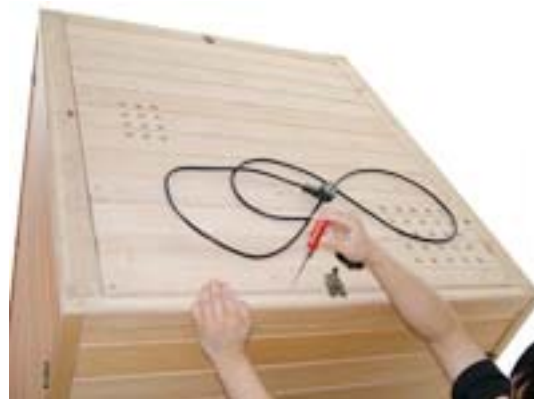
FIG-26 Fije el panel exterior con tornillos
