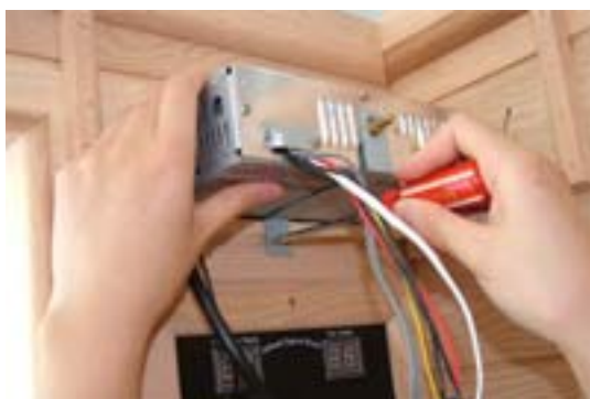
FIG-15.2 Fije el CD a los soportes metálicos
