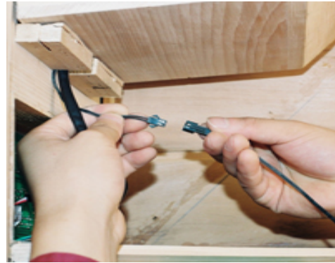
FIG-21 Conecte el cable del sensor
