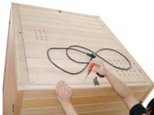
FIG-26 Afixe o painel de topo com os parafusos
