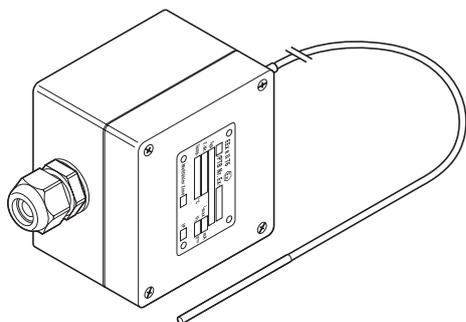
Sonde Pt 100 à 3 fils connectée à une boîte de raccordement noire en polyester renforcé de fibre de verre avec 4 bornes à ressort en façade. Presse-étoupe M20 EEx e préinstallé.
