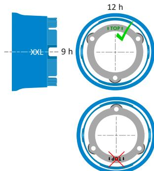
\*Per un montaggio semi-incastro, è necessario l'utilizzo di una flangia diritta. Va rispettato l'orientamento in fase di assemblaggio.
