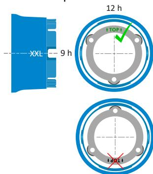
Para montaje semi-empotrado, hay que utilizar un codo recto y respetar su orientación cuando se monte.
