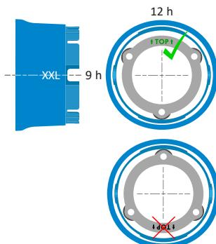
Tafeleinbaugeräte müssen mit einem geraden Adapter montiert werden.
