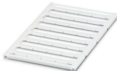
Repères pour blocs de jonction, à commander : sous forme de planche, blanc, impression selon les indications du client, type de montage: encliquetage dans la rainure de repérage plate, pour bloc de jonction au pas de : 16 mm, surface utile: 15,45 x 5,1 mm, Nombre d'étiquettes: 32
