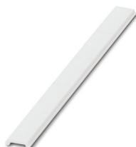
Ruban de repérage ZB, plat, Rubans, blanc, vierge, repérable avec : PLOTMARK, CMS-P1-PLOTTER, type de montage: encliquetage, pour bloc de jonction au pas de : 16 mm, surface utile: 16,25 x 10,5 mm, Nombre d'étiquettes: 50
