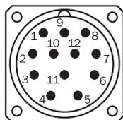
Vue connecteur d'appareil M23 sur le codeur
