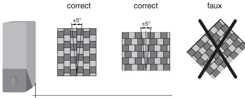
Le bord du détecteur et le bord du réflecteur doivent être parallèles !
