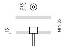
Wire Trimless Accessory est une collection d'accessoires qui permettent d'installer les tendeurs et les câbles des luminaires suspendus d'Arkosligh directement au plafond, sans rosette ni fixation apparente. Ceci permet d'obtenir une application minimaliste et visuellement propre dans l'espace.
