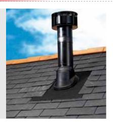
Le terminal **MULTIVENT** permet la ventilation des fosses septiques. C'est un terminal pour système d'extraction mécanique et naturelle avec une résistance à l'air particulièrement faible. Il comporte un système d'évacuation des condensats. Sa rotule est adaptée à la pente de toit et le système d'étanchéité se fait par tuile à douille.
