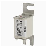
**Cartouche fusible, grande vitesse, 125 A, AC 690 V, 200 kA, DIN 00, aR, DIN, IEC, indicateur de type T, pattes d'extraction conductrices**
