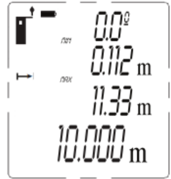
Fig. 6. Les possibilités d'une mesure continue pour mesurer une distance spécifiée (10m) à partir d'un mur
