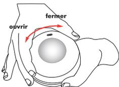
Le détecteur doit être monté sur une surface plane et solide. Avant le montage il faut enlever le couvercle en dévissant d'environ 5° dans le sens inverse des aiguilles d'une montre et le retirant.
