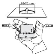
Le détecteur a été spécialement conçu pour un montage dans des plafonds suspendus. Une ouverture circulaire d'un diamètre de 68-70 mm doit auparavant être pratiquée dans le plafond.
