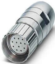
M23, Connecteurs à câble, série: UC, droit, blindé: oui, Verrouillage à vis, Nombre de pôles: 12, Sens de rotation: inversé, type de contact: Connecteur femelle, Raccordement à sertir, plage de diamètre de câble: 2 mm ... 14,5 mm, détrompage: N, Produit de remplacement selon RoHS II sans exception 6c (Pb < 0,1 %) référence : 1242128
