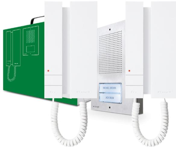
Composition du kit : 2 postes audio série Mini art. 2702W, 1 transformateur art. 1200, 1 platine extérieure avec 2 boutons d'appel série Extra art. ET5002. Le kit est extensible avec un autre poste audio pour chaque appel. La platine extérieure peut être montée en saillie ou encastrée avec les accessoires correspondants faisant partie du kit.
