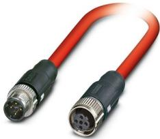
Câble de réseau, Sercos CAT5 (100 Mbit/s), 4-pôles, blindé, connecteur mâle droit M12 SPEEDCONNec, détrompage: D / IP67, sur Connecteur femelle droit M12 SPEEDCONNec, détrompage: D / IP67, longueur de câble: 5 m
