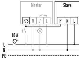
Raccordement maître/esclave. Un appareil maître peut être raccordé à 10 appareils esclaves au maximum.
