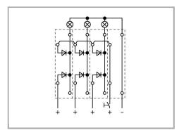
Bornes pour réaliser les circuits de test de lampes :
