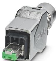
Connecteur RJ45, indice de protection: IP65/IP67, nombre de pôles: 8, 1 Gbit/s, CAT5, matériau: Métal, type de raccordement: Raccordement autodénudant IDC, section raccordable: AWG 23- 22, sortie du câble: droit, Ethernet
