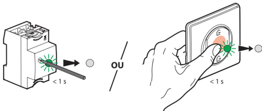
Pour terminer votre installation, appuyez **brèvement** sur le bouton de configuration du **Module Control** ou au centre de la **Commande générale sans fil Départ/Arrivée**.
