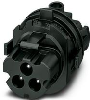
Porta-contatos, Famille d'articles: PRC 35, matériau du boîtier: PPE, coloris: noir, nombre de pôles: 3, section de fil min.: 1,5 mm<sup>2</sup>, section de fil max.: 6 mm<sup>2</sup>, tension de référence: 690 V AC, courant de référence: 35 A, Type de raccordement: Raccordement vissé, Type de contact: Mâle. Élément de contact sans boîtier de connecteur. Prière de commander le boîtier de connecteur adapté conformément à la liste des accessoires.
