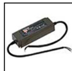
S.2406 ALIMENTATION ELECTRONIQUE NON GRADABLE 90W 230Vac/24Vdc IP67 Entrée: 230V Courant alterné Sortie: 24V Courant continu. Le nombre maximum d'appareils dépend de la somme des puissances unitaires de l'appareil. CLASSE II SELV Dimensions: 171 x 63 x 37,5 mm L'UTILISATION DU DÉCHARGEUR À SURTENSION S.2499 EST RECOMMANDÉE POUR CHAQUE BALLAST ÉLECTRONIQUE QUI DOIT ÊTRE INSTALLÉ À UNE DISTANCE MAXIMALE DE 10m DE CELUI-CI.
