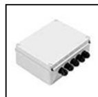
S.2402 ALIMENTATION ELECTRONIQUE NON GRADABLE IN BOX 60W 230Vac/24Vdc IP55 Dimensions: 260 x 240 x 100 mm En entrée: N° 2 presse étoupes PG 11 En sortie: N° 5 presse étoupes PG 11 CLASSE ELETRIQUE II SELV Le nombre maximum d'appareils dépend de la somme des puissances unitaires de l'appareil. L'UTILISATION DU DÉCHARGEUR À SURTENSION S.2499 EST RECOMMANDÉE POUR CHAQUE BALLAST ÉLECTRONIQUE QUI DOIT ÊTRE INSTALLÉ À UNE DISTANCE MAXIMALE DE 10m DE CELUI-CI.
