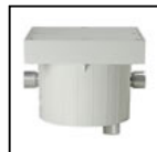
S.3660 BOÎTE DE JONCTION IP65* Puisarde de dérivation pour câblage fourni avec presse-étoupe pour 3 entrées (3 entrées supplémentaires que l'on peut ouvrir avec l'accessoire S.3670) Charge maximum 500 Kg. Dimensions 300mmx300mmx230mm
