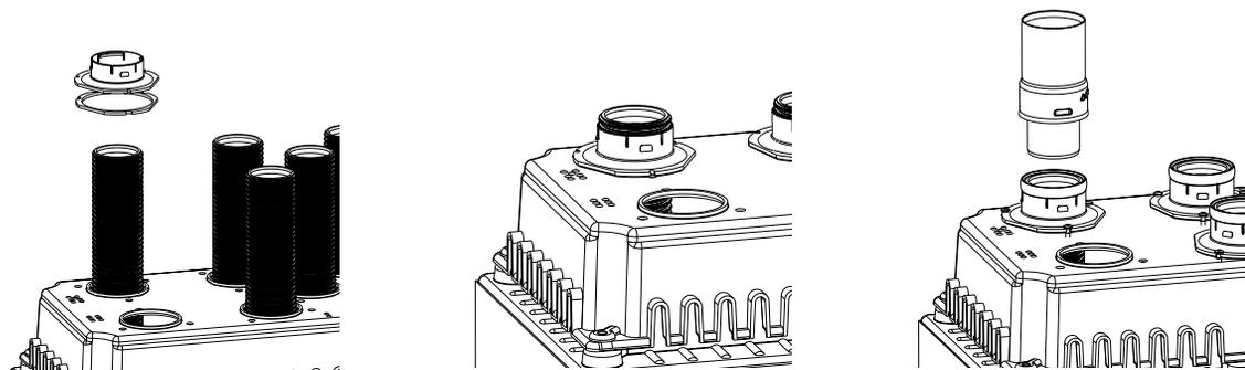
9. Fixer le cache sur le trou non utilisé du couvre cheminée et ajouter la grille anti-volatiles sur chaque embout de terminal.
