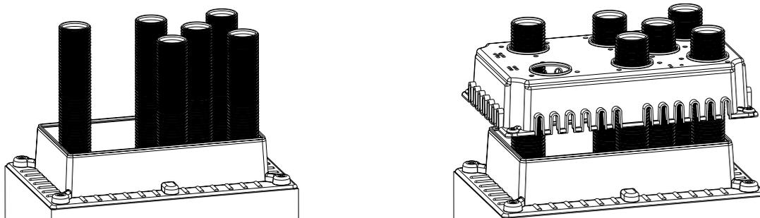
8. Coller le joint sur la bague du terminal, et enfiler le tout sur le flexible. Tendre le flexible par la même occasion.
