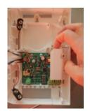
7. Retirer le circuit du dispositif lumineux
