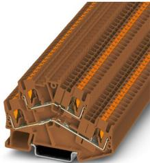
Bloc de jonction à deux étages, tension nominale: 500 V, intensité nominale: 22 A, type de raccordement: Raccordement Push-in, 1er et 2e étage, Section de référence: 2,5 mm<sup>2</sup>, section : 0,14 mm<sup>2</sup> - 4 mm<sup>2</sup>, type de montage: NS 35/7,5, NS 35/15, coloris: marron
