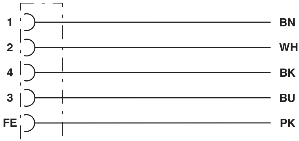
Schéma de connexion
