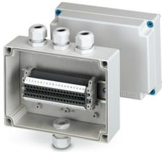
Coffret de commande, avec 20 blocs de jonction de 2,5 mm<sup>2</sup> à raccordement vissé, matériau: ABS, gris, 180 mm x 130 mm x 100 mm, type de verrouillage: Couvercle vissé
