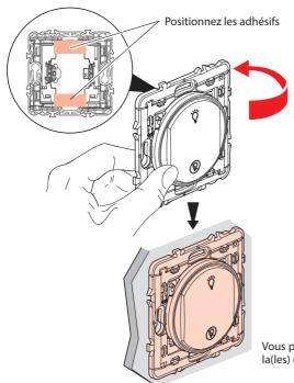
Avant de fixer la(les) commande(s) sans fil à l'aide des adhésifs repositionnables fournis, faites un test sur une zone non visible du mur.
