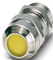
Presse-étoupe, matériau du raccordement vissé: Laiton, nickelé, application: Ex, diamètre extérieur du câble 16 mm ... 28 mm, blindage: oui, filetage de raccordement: M40 x 1,5, coloris: argenté, avec joint torique
