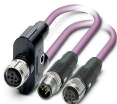
Câble préconfectionné pour bus, CANopen<sup>®</sup>, DeviceNet<sup>™</sup>, 5-pôles exempt d'halogène, blindé, Connecteur femelle droit M12, détrompage: A, sur connecteur mâle droit M12, détrompage: A et Connecteur femelle droit M12, détrompage: A, longueur de câble: 0,5 m, Connecteur M12, blindé, Répartiteur en Y non blindé, blindage placé sur la broche 1
