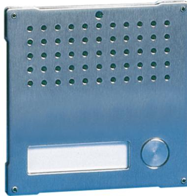
Module double plaque en acier inox 316 de 2,5 mm. À compléter avec groupe audio correspondant au système de câblage utilisé. Module 1 bouton. Dimensions 106x106x44 mm
