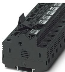
Porte-fusibles, type de fusible: Verre / Céramique / ..., type de fusible: gPV 10,3 x 38 mm selon la norme 60269-6, tension nominale: 1000 V DC, intensité nominale: 30 A, type de raccordement: Raccordement vissé, Section de référence: 16 mm<sup>2</sup>, section : 1,5 mm<sup>2</sup>- 25 mm<sup>2</sup>, type de montage: NS 35/7,5, NS 35/15, coloris: noir
