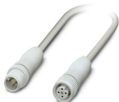
Câble pour capteurs/actionneurs, 4-pôles exempt d'halogène, connecteur mâle droit M12, détrompage: A, câblé avec déconnecté, sur Connecteur femelle droit M12, détrompage: A, longueur de câble: 0,6 m, Conception hygiénique, avec molette plastique
