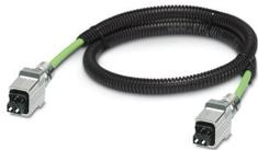
Câble fibre optique pré-équipé, câble PROFINET type B, fibre PCF 200/230  $\mu\text{m}$ , boîtier métallique Push-Pull SC-RJ/IP67 sur BFOC(ST)/IP20, gaine extérieure en PVC, sans halogène, résistant à l'ozone et aux UV, dans une gaine de protection, pour pose fixe à l'intérieur, longueur : 3,5 m
