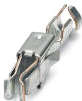
Contact femelle modulaire, à enfiler dans le capot MSTBC après sertissage du conducteur, pour conducteurs de 1,5 à 2,5 mm<sup>2</sup>, sous forme de ruban
