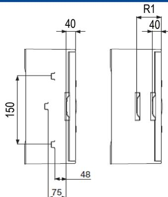
**Pattes de fixation ST VTR/ ST VTR INOX**
