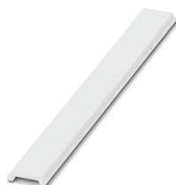
Ruban de repérage ZB, plat, à commander : par bandes, blanc, impression selon les indications du client, type de montage: encliquetage dans la rainure de repérage plate, pour bloc de jonction au pas de : 12 mm, surface utile: 5,15 x 12,15 mm, Nombre d'étiquettes: 5
