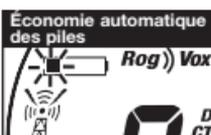
Lorsque les piles sont faibles, la barre finale de l'icône **Battery Low (piles faibles)** clignote et une tonalité sonore retentit deux fois avant que la radio ne s'éteigne. Vos piles doivent être remplacées ou rechargées, si vous utilisez des piles rechargeables.
