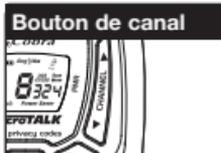
Lorsque la radio est allumée, sélectionnez l'un des 8 canaux en appuyant sur le bouton **Channel Up (Canal supérieur)** ou **Channel Down (Canal inférieur)**.
