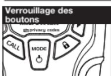
La fonction **Lock (Verrouillage)** verrouille les boutons **Channel Up (Canal supérieur)**, **Channel Down (Canal inférieur)**, **Volume Up (Augmentation du volume)**, **Volume Down (Réduction du volume)** et **Mode/Power (Mode/Alimentation)** pour éviter toute pression accidentelle.
