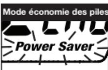
S'il n'y a pas de transmissions dans les 10 secondes, la radio passe automatiquement en mode **Battery Save (Économie des piles)** et l'icône **Power Saver (Économie d'énergie)** clignote sur l'écran. Cela n'affectera pas la capacité de la radio à recevoir les émissions entrantes.
