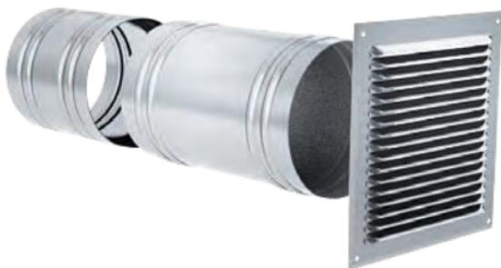
L'ensemble constitué du manchon fixe de longueur 250 mm et du manchon de réglage de longueur 200 mm permet d'assurer la traversée de murs d'épaisseurs 250 à 400 mm.
