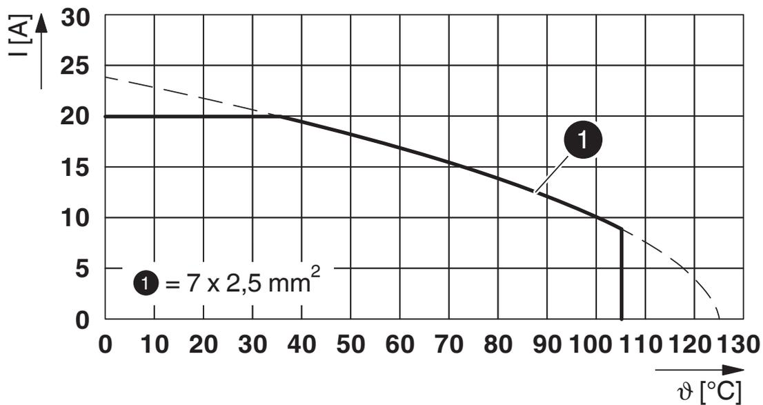
$I$  = intensité,  $\vartheta$  = température ambiante, 7x 20 A
