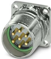
M23, Embases paroi avant, série: M23 PRO, droit, Pour verrouillages rapides standard et ONECLICK, Nombre de pôles: 7, Sens de rotation: standard, type de contact: Mâle, Raccordement à sertir, 4x Ø2,7, cote de bride: 26 mm x 26 mm, détrompage: N, L'article est sans plomb, conformément à la directive RoHS II, sans exception 6c (Pb < 0,1 %)
