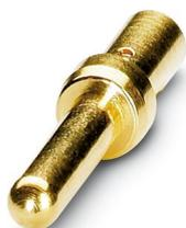
Contact à sertir, Mâle, tournés, Contact unique, diamètre de contact: 2 mm, zone de sertissage: 0,75 mm<sup>2</sup> ... 1 mm<sup>2</sup>, Produit de remplacement selon RoHS II sans exception 6c (Pb < 0,1 %) référence : 1241632
