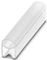
Repères pour fils, transparent, vierge, type de montage: enfilage, plage de diamètre de câble: 1,5 ... 2,5 mm, surface utile: 30 x 4 mm
