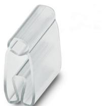
Repères pour fils, transparent, vierge, type de montage: enfilage, plage de diamètre de câble: 6 ... 10 mm, surface utile: 15 x 4 mm
