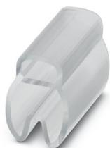
Repères pour fils, transparent, vierge, type de montage: enfilage, plage de diamètre de câble: 4 ... 7 mm, surface utile: 12 x 4 mm
