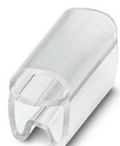
Repères pour fils, transparent, vierge, type de montage: enfilage, plage de diamètre de câble: 1,5 ... 2,5 mm, surface utile: 10 x 4 mm
