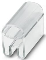
Repères pour fils, transparent, vierge, type de montage: enfilage, plage de diamètre de câble: 2 ... 4 mm, surface utile: 10 x 4 mm
