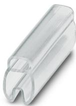
Repères pour fils, transparent, vierge, type de montage: enfilage, plage de diamètre de câble: 4 ... 7 mm, surface utile: 23 x 4 mm
