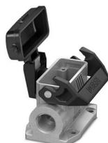
Embase en saillie D15, avec étrier longitudinal, matériau: Aluminium coulé sous pression, résistant à l'eau de mer, matériau du couvercle de protection: PC, nombre de sorties: 2, latérale, 2x M25, hauteur: 52 mm, presse-étoupe: sans, capot de protection: oui, Standard
