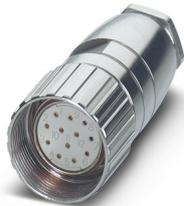
M23, Connecteurs à câble, série: RC, droit, blindé: non, Verrouillage à vis, Nombre de pôles: 16, Sens de rotation: standard, type de contact: Connecteur femelle, Cône de soudage, plage de diamètre de câble: 8 mm ... 12 mm, détrompage: N, Produit de remplacement selon RoHS II sans exception 6c (Pb < 0,1 %) référence : 1241254
