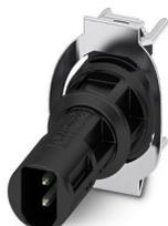
Connecteurs pour circuits imprimés du dispositif de protection sensible, type: IEC 63171-5, indice de protection: IP20, nombre de pôles: 2, 10 Gbit/s, CAT B (ISO/IEC 63171), matériau: Plastique, type de raccordement: Raccordement soudé THR, Single Pair Ethernet
