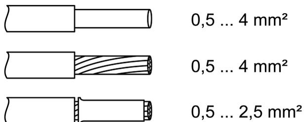
Figure 4: Section transversale de conducteur pouvant être bloquée
