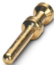
Contact à sertir, diamètre de contact: 2,5 mm, tournés, Mâle, matériau de contact: Alliage de cuivre, surface des contacts: doré, section raccordable: 0,5 mm<sup>2</sup> ... 0,5 mm<sup>2</sup>, AWG 20
