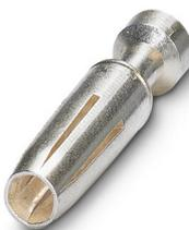
Contact à sertir, diamètre de contact: 2,5 mm, tournés, Connecteur femelle, matériau de contact: Alliage de cuivre, surface des contacts: plaqué argent, section raccordable: 0,75 mm<sup>2</sup> ... 1 mm<sup>2</sup>, AWG 18
