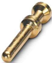
Contact à sertir, diamètre de contact: 2,5 mm, tournés, Mâle, matériau de contact: Alliage de cuivre, sans plomb, surface des contacts: doré, section raccordable: 2,5 mm<sup>2</sup> ... 2,5 mm<sup>2</sup>, AWG 14
