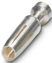
Contact à sertir, diamètre de contact: 2,5 mm, tournés, Connecteur femelle, matériau de contact: Alliage de cuivre, sans plomb, surface des contacts: plaqué argent, section raccordable: 1,5 mm<sup>2</sup> ... 1,5 mm<sup>2</sup>, AWG 16
