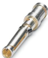
Contact à sertir, diamètre de contact: 1,6 mm, tournés, Connecteur femelle, matériau de contact: Alliage de cuivre, sans plomb, surface des contacts: plaqué argent, section raccordable: 0,5 mm<sup>2</sup> ... 0,5 mm<sup>2</sup>, AWG 20
