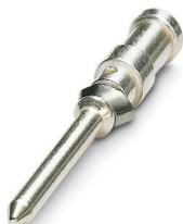
Contact à sertir, diamètre de contact: 1,6 mm, tournés, Mâle, matériau de contact: Alliage de cuivre, sans plomb, surface des contacts: plaqué argent, section raccordable: 0,5 mm<sup>2</sup> ... 0,5 mm<sup>2</sup>, AWG 20
