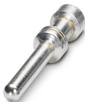
Contact à sertir, diamètre de contact: 2,5 mm, tournés, Mâle, matériau de contact: Alliage de cuivre, sans plomb, surface des contacts: plaqué argent, section raccordable: 4 mm<sup>2</sup> ... 4 mm<sup>2</sup>, AWG 12
