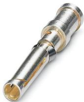
Contact à sertir, diamètre de contact: 1,6 mm, tournés, Connecteur femelle, matériau de contact: Alliage de cuivre, surface des contacts: plaqué argent, section raccordable: 0,5 mm<sup>2</sup> ... 0,5 mm<sup>2</sup>, AWG 20
