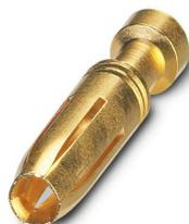
Contact à sertir, diamètre de contact: 2,5 mm, tournés, Connecteur femelle, matériau de contact: Alliage de cuivre, surface des contacts: doré, section raccordable: 0,5 mm<sup>2</sup> ... 0,5 mm<sup>2</sup>, AWG 20
