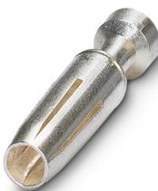
Contact à sertir, diamètre de contact: 2,5 mm, tournés, Connecteur femelle, matériau de contact: Alliage de cuivre, surface des contacts: plaqué argent, section raccordable: 0,5 mm<sup>2</sup> ... 0,5 mm<sup>2</sup>, AWG 20
