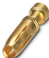
Contact à sertir, diamètre de contact: 2,5 mm, tournés, Connecteur femelle, matériau de contact: Alliage de cuivre, sans plomb, surface des contacts: doré, section raccordable: 2,5 mm<sup>2</sup> ... 2,5 mm<sup>2</sup>, AWG 14
