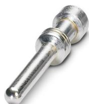
Contact à sertir, diamètre de contact: 2,5 mm, tournés, Mâle, matériau de contact: Alliage de cuivre, surface des contacts: plaqué argent, section raccordable: 0,75 mm<sup>2</sup> ... 1 mm<sup>2</sup>, AWG 18
