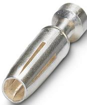
Contact à sertir, diamètre de contact: 2,5 mm, tournés, Connecteur femelle, matériau de contact: Alliage de cuivre, surface des contacts: plaqué argent, section raccordable: 0,75 mm<sup>2</sup> ... 0,75 mm<sup>2</sup>, AWG 18
