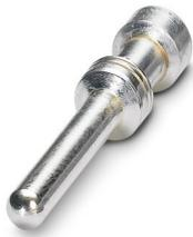
Contact à sertir, diamètre de contact: 2,5 mm, tournés, Mâle, matériau de contact: Alliage de cuivre, surface des contacts: plaqué argent, section raccordable: 2,5 mm<sup>2</sup> ... 2,5 mm<sup>2</sup>, AWG 14, Contact retardé
