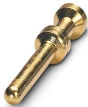
Contact à sertir, diamètre de contact: 2,5 mm, tournés, Mâle, matériau de contact: Alliage de cuivre, surface des contacts: doré, section raccordable: 2,5 mm<sup>2</sup> ... 2,5 mm<sup>2</sup>, AWG 14
